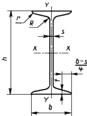
$h$  - высота двутавра;  $b$  - ширина полки;  $s$  - толщина стенки;  $t$  - средняя толщина полки;  $R$  - радиус внутреннего закругления;  $r$  - радиус закругления полки
